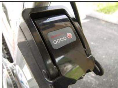
Quando la batteria comincia a scaricarsi si spengono in sequenza le spie a partire da sinistra verso destra. Ad esaurimento della batteria resta accesa solo una spia rossa. In tal caso è necessario smettere immediatamente di usare il motore elettrico e procedere al più presto alla ricarica della batteria.
