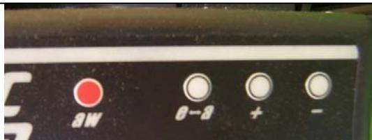
La funzione di camminata assistita "aw" permette di condurre a mano la bicicletta senza sforzo e la velocità max in questa funzione è di circa 5 km/h.
