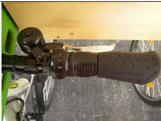
Il modulatore di velocità posto sul lato destro del manubrio serve a regolare la velocità della bicicletta nella modalità "e". Sul modulatore sono presenti 3 spie:
