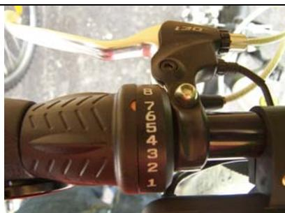
La bicicletta è dotata di deragliatore posteriore a 8 velocità utile in particolare ad affrontare le salite più ripide. Il cambio di velocità è azionabile mediante il comando indicizzato a manopola posto sul lato sinistro del manubrio, dove è possibile visualizzare il rapporto utilizzato indicato sulla manopola di cambio.
